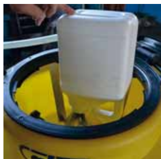
Široký plnicí otvor nádrže s nožovou nerezovou hlavou, která zajišťuje proříznutí plastového pytle nebo proříznutí ochranné folie v hrdle kanystru
