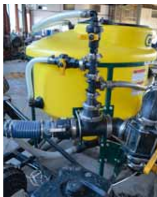
Armatura s napojením systému míchacích a vyplachovacích trysek
