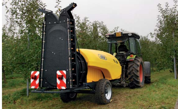
Nový rosič AKP TRS 1500 je určen do sadů, oproti viničnímu modelu je vybaven deflektorem
