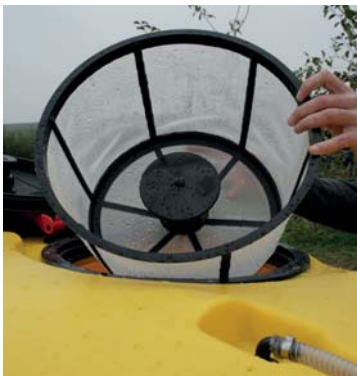
Tryska na přípravu postřiku, granulát se nasype do síta, v němž se rozpustí a je vmíchán do obsahu nádrže
