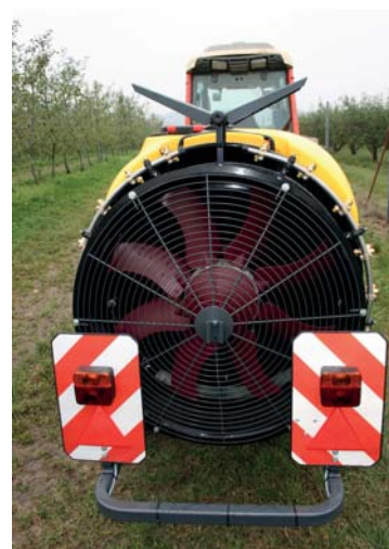
Výkon vzadu umístěného ventilátoru o průměru 800 mm se mění naklápěním jeho osmi lopatek
