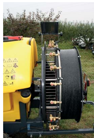
Rosiče do vinic je osazen 14 otočnými držáky trysek s protiodkapem
