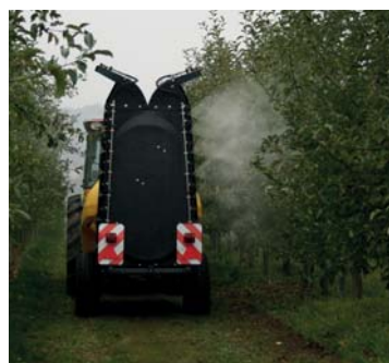
Úlet bylo možné posoudit vizuálně při zkušební jízdě. Vpravo pracují standardní kuželové trysky ATR vytvářející jemnou mlhovinu, vlevo nové injektorové trysky TVI
