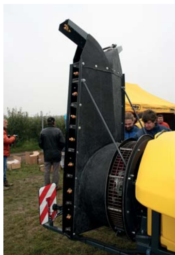
Deflektor na sadařském rosiči má za úkol usměrnit proud vzduchu tak, aby pokryl celou plochu jednotlivých stromů v řadě
