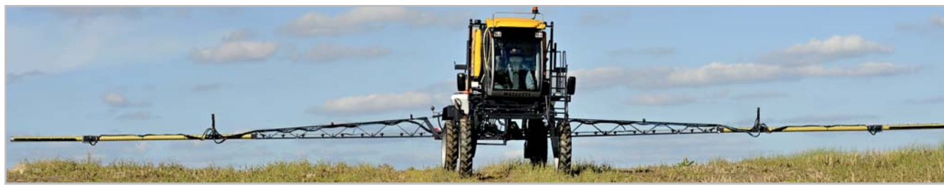
Nový model postřikovače IBIS 3000 LP může mít světlou výšku podvozku až 170 cm
