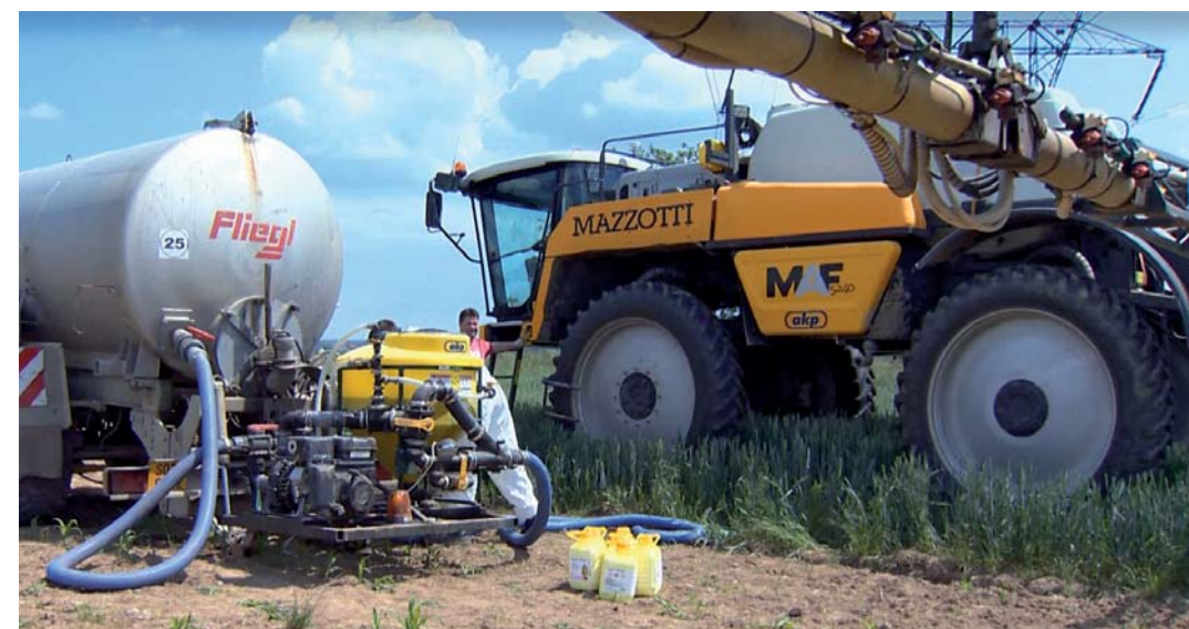
Rychloplnicí zařízení EDDY při plnění „samochodu“ AKP Mazzotti MAF 5240 s objemem nádrže 5000 litrů
