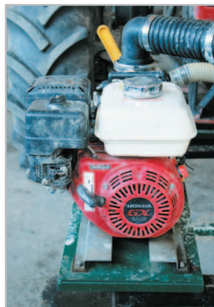
Pohon čerpadla zajišťuje malý benzinový motor Foto Jiří Hruška
