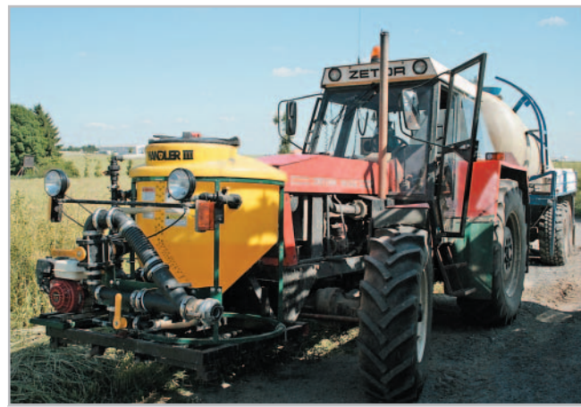
Rychloplnicí zařízení je zavěšeno na traktoru Foto Jiří Hruška
