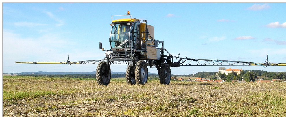
Ramena postřikovačů vyrobená z uhlíku jsou odolná a do určité míry zatížení vůbec neznají únavu materiálu, běžnou u kovových konstrukcí
