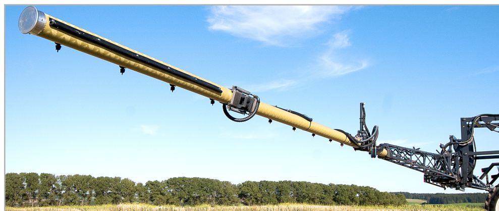
Ocelo-karbonová ramena AKP OC-C o záběru 24 metrů
