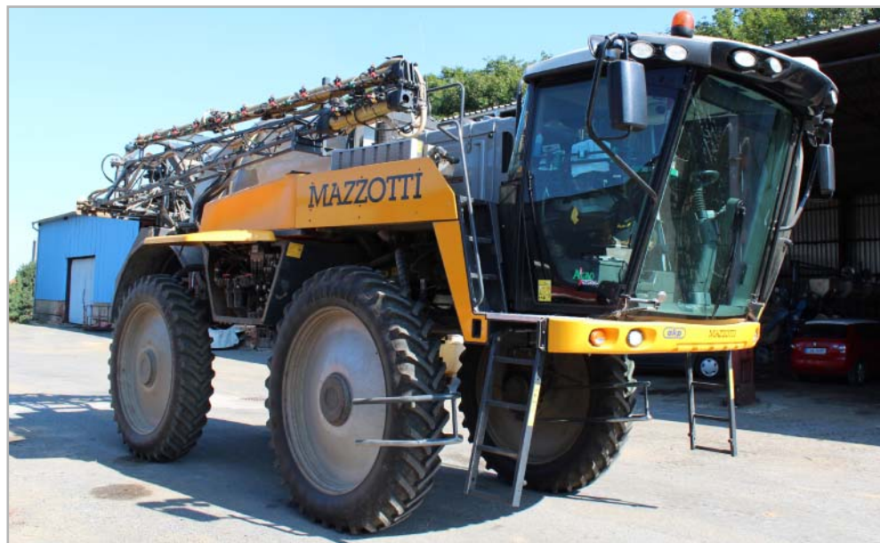
Mazzotti MAF má světelnou výšku 150 cm, kabinu Claas, motor Perkins a lehká ramena od AKP Foto Jiří Hruška
