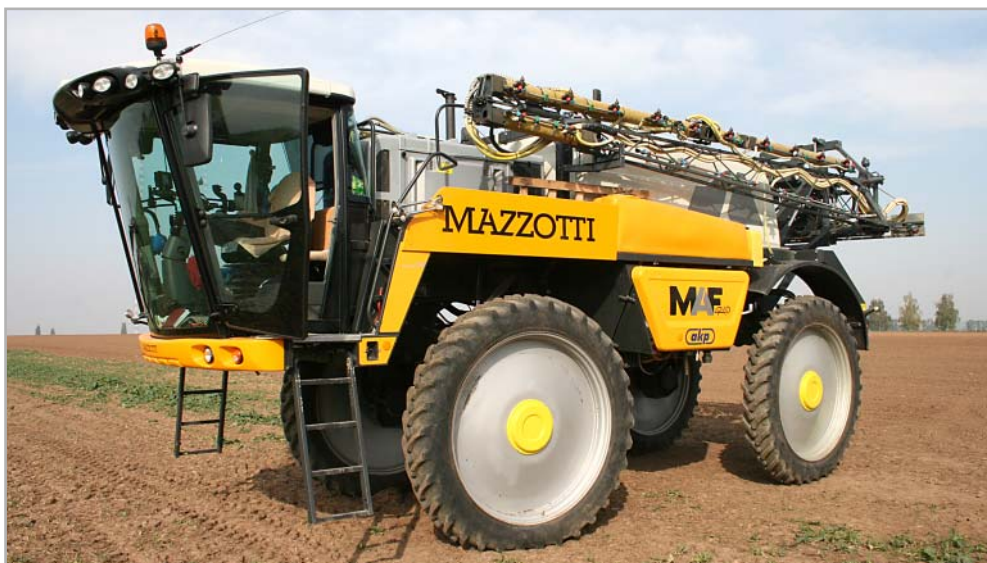
Světla výška 150 cm je pro službaře jedním z nejdůležitějších parametrů stroje Foto Jiří Hruška
